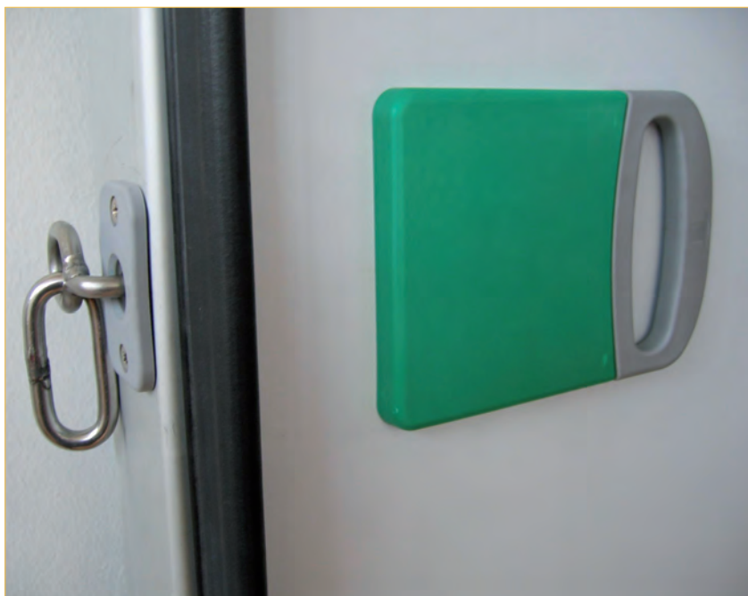
Sgancio interno di apertura Inside release
